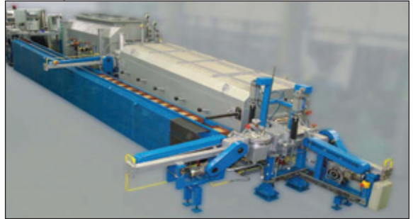
Bild 10: Sinterofen für PM-Teile (ELINO Ofenbau GmbH)
