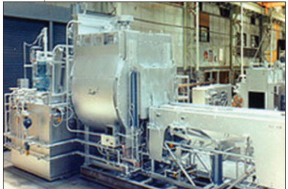
Bild 12: Anlage zum Abschrecken in Öl (Hoeganaes Corp.)
