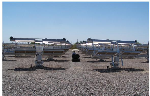
Korrelationsstudien zeigen, dass Q-TRAC besonders nützlich für Band-, Pulver- und Baustoffbeschichtungen und bestimmte Kunststoffe ist.
