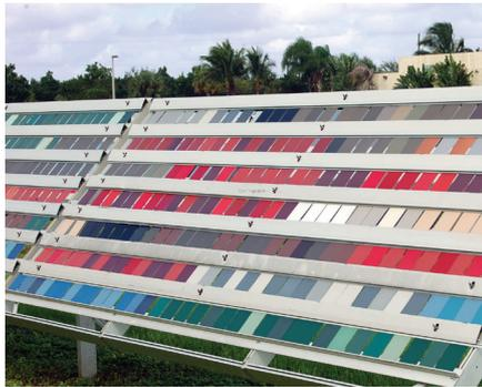
Beständigkeit gegen Sonnenlicht und Feuchtigkeit ist ein fundamentales Maß für die Produkthaltbarkeit.
