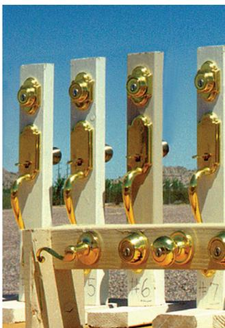
Q-Lab führt die Bewitterung von Platten, Teilen, Komponenten und Baugruppen durch.
