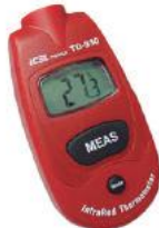
Termômetro Infravermelho TD930 ICEL • Visor de Cristal Líquido (Lcd) • funções: Temperatura em °C ou °F • Registro de máximo e mínimo, e desligamento automático • Indicação de pilha fraca: O visor exibirá o símbolo de uma pilha • Seleção de escalas: automática (-35 °C a +230 °C / -31 °F a +446 °F) • Temperatura de Armazenagem: de -10°C a +60°C • Umidade relativa de operação: de 10 a 90% sem condensação • alimentação: 1 x Cr2032 • Duração da pilha: 40 Horas de uso contínuo • Desligamento automático: Após 15 segundos • Taxa de amostragem: 1 segundo • Emissividade: 0,95 035336
