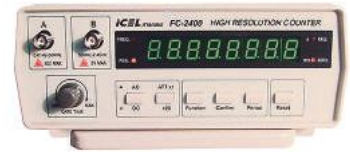
Frequencímetro FC2400 ICEL • Display Led: 8 Díg. • Freqü: 50M e 2.400MHz • Resol: 0,01 a 1kHz • Sensib: 30m Vrms • Período: De 20n a 2S • Base de Tempo: TCXO • WARM-UP: 10 min. • Conec. tipo BNC • Exatidão da Freq: ± (2PPM + 1D) • Imped. de Entr: 50/1MΩ • Atenuação: X1 e X20 • 127/220V • (270x215x100mm) • Peso: 1,6Kg 033003
