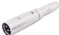
XLR M/P10 Mono F • Adaptador de níquel XLR(canon) macho 3 pinos para jack P10(6,35mm) mono fêmea • Emb. 5 pçs 035304
