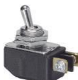
Chave Alavanca MARGIRIUS • Interruptor 6A com carga resistiva em 120v~ ou 3A com carga resistiva em 250v~ • Unipolar 034956 - CS-301D-MB1P1
