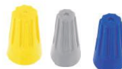
Emendas Rosqueáveis Crimper • Isolação: 1000V • Temperatura máxima 105°C • Embalagens: 100 pçs 033429 Bitola 0,8 a 4,5mm 2 . AZ 033368 Bitola 0,8 a 2,5mm 2 . CZ 033369 Bitola 1,5 a 6,0mm 2 . LJ 033370 Bitola 1,5 a 10 mm 2 . AM 033371 Bitola 4,5 a 17mm 2 . VM
