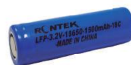
3,2V 1500mAh • LiFePO 4 • Descarga máx: 4.500mA • 3C • 18x65mm 035751
