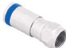
Tipo F • Conector F macho • Compressão com anel 033288 RG-59/U (75R) AZ Emb c/ 1pç 035924 RG-6/U (75R) AM Emb c/ 10pçs 033287 RG-6/U (75R) AZ Emb c/ 1pç
