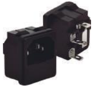
Tomada Painel • Tomada com fixação por pressão, ligação dos fios por solda ou terminal faston • Porta fusível 5x20mm 10A/250Vac • 3 Terminais • PT 030270
