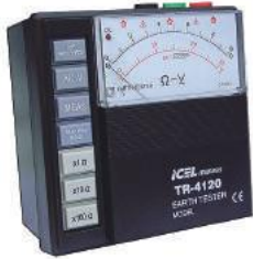
Terrômetro TR4120 ICEL • Analógico • Escalas: 10/100/1.000Ω • Exatidão: 3% do F.E. • Tensão de terra: 30V AC (50Ω/V) • Galvanômetro: Tipo "pivot manca" • 8 pilhas de 1,5V AA • Maleta para transporte 033002
