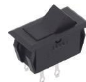
Chave Tecla MARGIRIUS • Interruptor 6A com carga resistiva em 120Vac (contato Q) • Bipolar 034967 - 15223-MFT1FPQ1S
