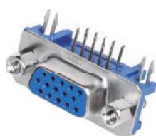
D-Sub HD Ângulo Reto p/ PCI Curto • DB15 fêmea HD • Connfly • Distância entre os terminais: 4,8mm 031871 DB15 HD - Emb: 9 pçs
