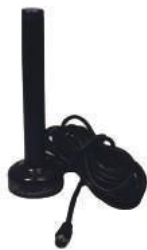
Antena Digital Portatil Interna • Antena de Tv Digital • Recebe Sinais Vhf/uhf/hdtv/fm • Frequências:45-862mhz. • ganho de Amplificador: 4db, Vswr: 1,5 • Impedância: 75 Ohms. Cabo Coaxial de 5 Mt Com Conector Macho 035892
