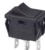
Chave Tecla MARGIRIUS • Interruptor 6A com carga resistiva em 120v~ ou 3A com carga resistiva em 250Vac (contato S) • Unipolar 034964 - 16101 MFTFE2S
