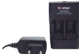
Carregador p/ Bateria de LiFePO4 • P/1 Bateria de LiFePO4 • Bivolt • Entrada 127/220 CA • Saída CC 3,65V - 1A 036410
