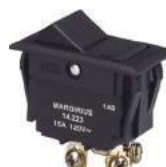
Chave Tecla MARGIRIUS • Interruptor 15A com carga resistiva em 120v~ ou 10A com carga resistiva em 250Vac (contato Q) • Bipolar 034966 - 14223- MFT1FP1Q
