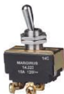
Chave Alavanca MARGIRIUS • Interruptor 15A com carga resistiva em 120v~ ou 10A com carga resistiva em 250v~ (contato Q) • Bipolar 034965 - 14223A1B1P1Q
