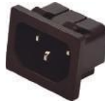
Tomada Painel • Tomada com fixação por pressão, ligação dos fios por solda • 10A / 250 Vac • 3 Terminais • PT 030271 - 15A 035409 - 10A
