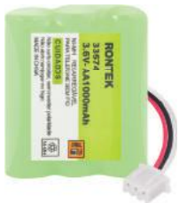
3,6V 1000mAh • NiMH • Conector JST-XHR-3P • 3xAA • (12x44x47mm) 033574
