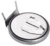
3V (CR2032) • Lítio (20x3,2mm) com 3 terminais • Para placa de circuito impresso • Distância entre terminais: 17,8mm 034947 Emb c/20pçs 034913 Emb c/100pçs
