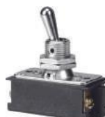
Chave Alavanca MARGIRIUS • Interruptor bipolar 10A com carga resistiva em 120v~ ou 6A com carga resistiva em 250v~ ½ Cv em 20/250v~ 034955 - CS-301C-MB1S/SS
