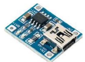
Carregador p/ bateria de Li-Ion • Tensão de Entrada: 4.5v ~ 5.5v - • Tensão de Saída: 4.2v • Corrente de carga: 1A • Conector Mini USB - 2,7x1,9x0,5mm p/ 1 bateria chip TP4056 036525
