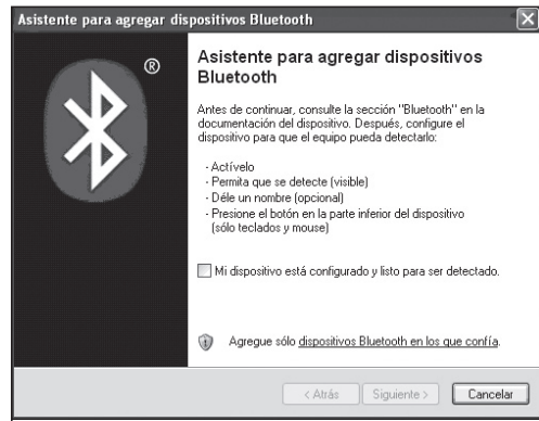
Figura 4.37. Asistente para configurar una conexión Bluetooth en Windows XP.
