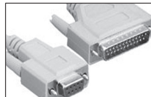
Figura 4.11. Interfaz EIA-232 con conectores DB-25 y DB-9.
