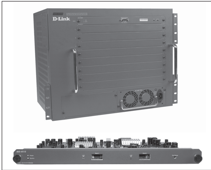
Figura 7.36. Chasis para switch de backbone y tarjeta 10-Gigabit Ethernet.
