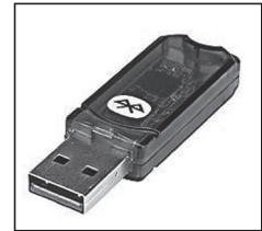
Figura 4.30. Interfaz Bluetooth para su conexión a un PC a través de un puerto USB.
