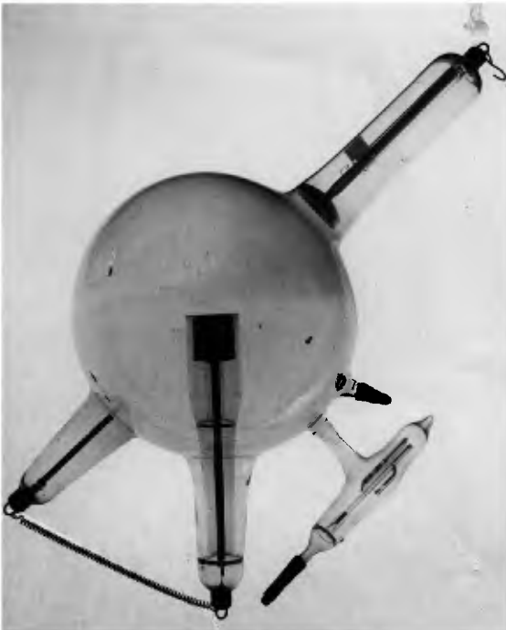
Gasgevulde röntgenbuis met mica-regulatie, omstreeks 1912. Foto.
