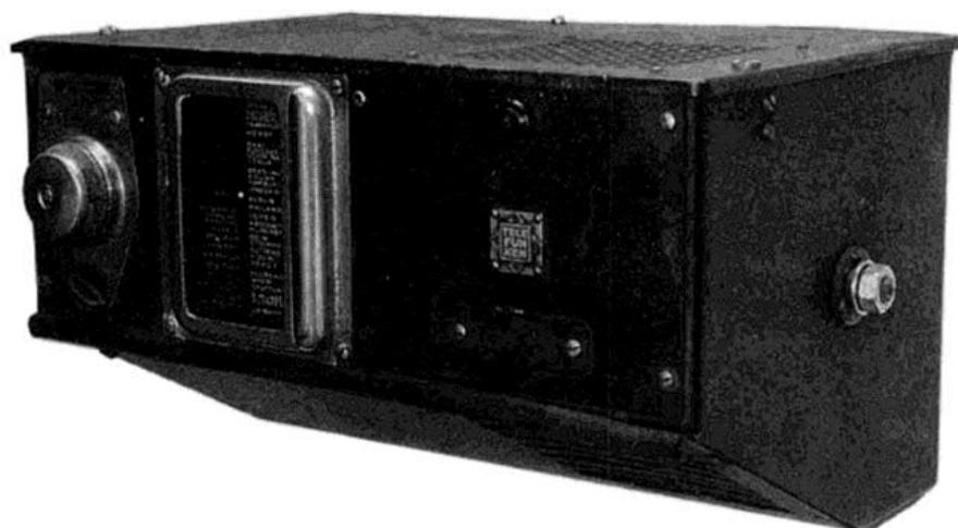
Der T 540 besticht durch seine kompakte Bauform. Der Nachfolger T 541 ist mit den neuen Autoröhren ausgestattet. Die Bauform scheint aber die gleiche gewesen zu sein.
