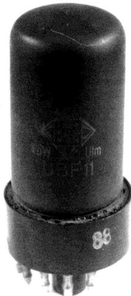
Glas-UBF11 aus der Fertigung des Telefunken-Röhrenwerkes Ulm
