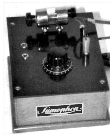
Bild 2: Lumophon-Detektor-Empfänger „MS“ von 1927 im Holzkasten mit Firmenschildchen. Die Trolit-Montageplatte trägt Angaben zur Funktion – nach einer Typenbezeichnung sucht man vergeblich.
