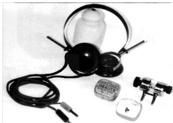
Bild 4: Lumophon-Zubehör für Detektor-Apparate aus den 20er Jahren. Der Doppel-Kopfhörer, Typ J, und der Präzisions-Detektor mit nicht selten dazu gehörendem Ersatzkristall, hier IDEALIT B.
