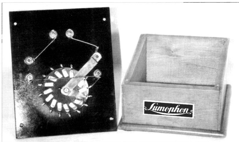
Bild 3: Blick auf das Innenleben des Detektor-Apparates „MS“ mit dem Dreh-Stufenschalter zur Senderabstimmung. Unter diesem ist die 8 mm dicke Lagenspule aus Kupfer-Seiden-Draht platziert.
