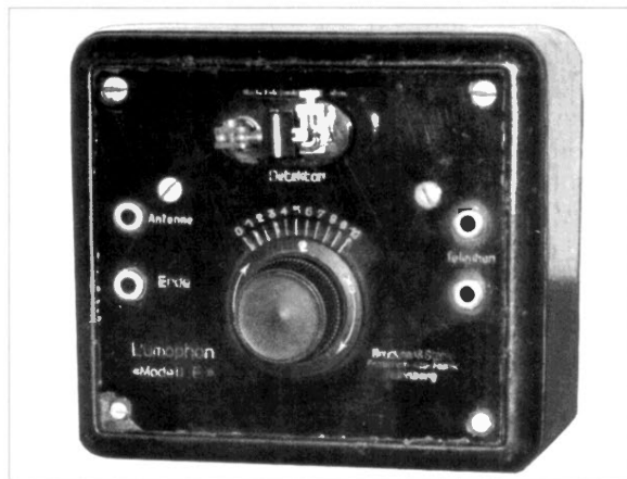
Bild 1: Lumophon-Detektor-Empfänger „F“ von 1926 im schwarz lackierten Metallgehäuse. In die Trolit-Montageplatte sind Angaben zum Hersteller, zum Typ und zur Funktion eingeprägt.
