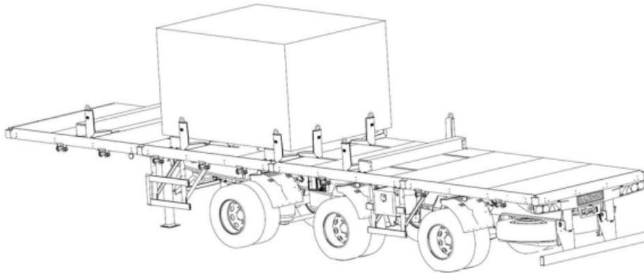
Para el transporte 02 bloques de piedra G1, el primer bloque debe ser puesto en los apoyos 1 y 2, y el segundo bloque en los apoyos 3 y 4, de acuerdo como muestra la figura abajo;
