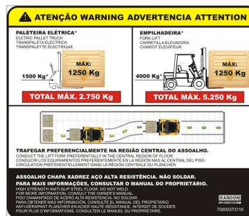
Para maximizar la vida útil del piso en productos con operación de montacargas y tranpaletas, preferiblemente viaje sobre la región central del piso con las ruedas del equipo en los miembros laterales del chasis.
