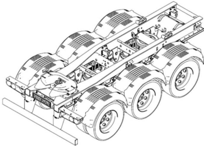
Proyectado para operaciones de carga y descarga del primer bitrén de la combinación, usando la parte trasera del equipo, debido a la posibilidad de realizar el deslizamiento de la base y caja de carga del bitrén delantero sobre el chasis; la quinta rueda permanece en posición fija. El movimiento a través de tracción del tracto camión es caracterizado por el deslizamiento del conjunto base más la caja de carga sobre el chasis deslizante, que permanece en posición fija.
