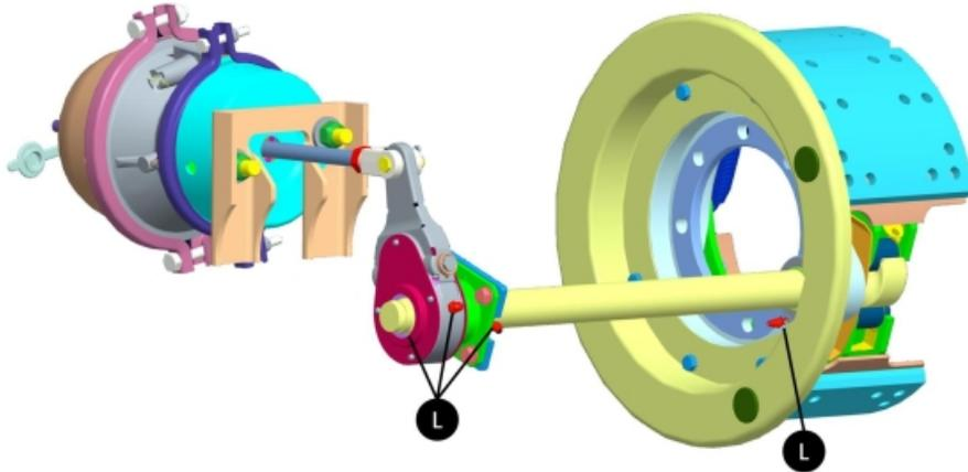
Los frenos serie "Q-Plus", son ensamblados con diámetro de 16.1/2", anchura de 8", con balatas cónicas.
