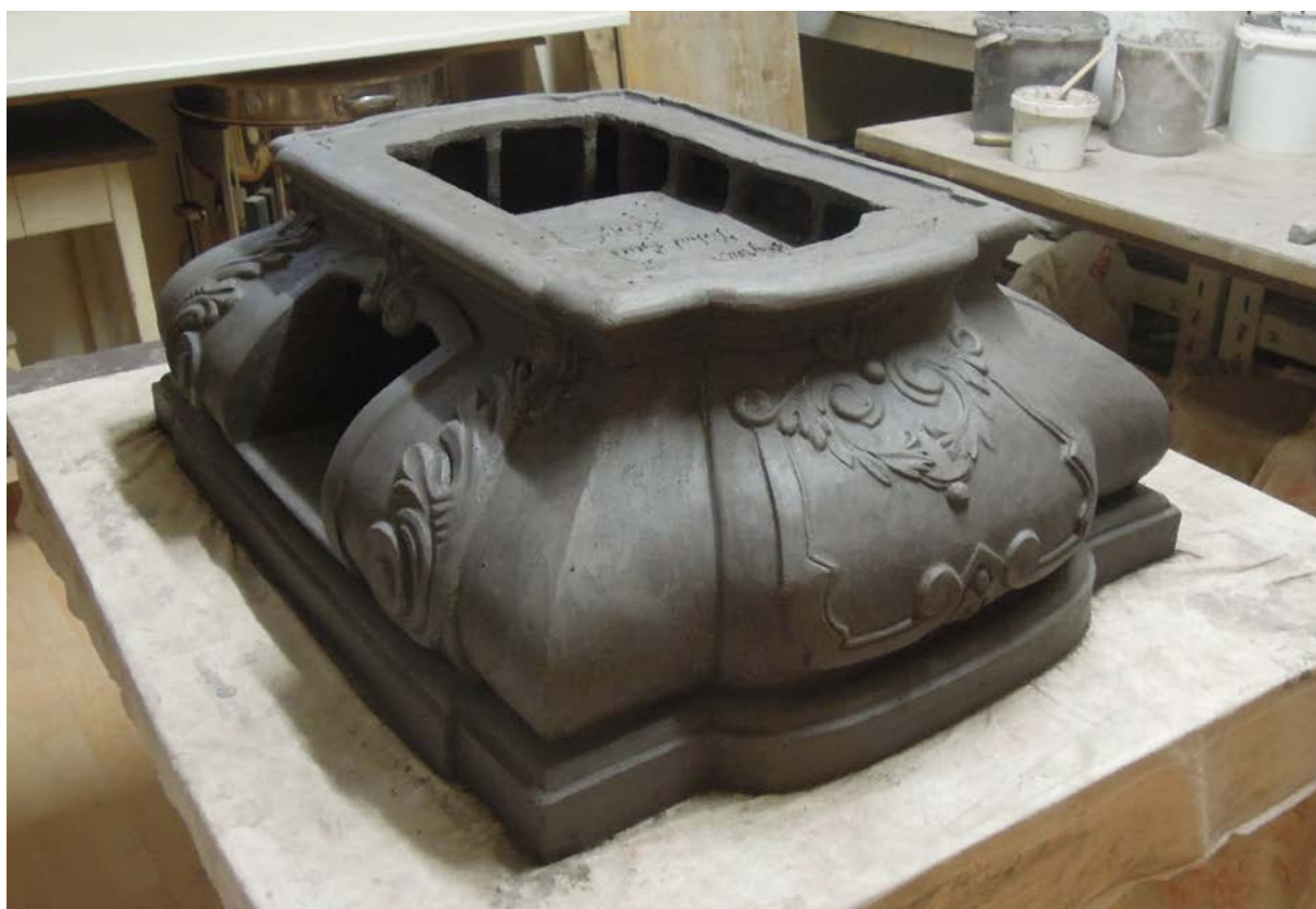
Ostatní nedochované kachle byly vytvořeny na základě analogie s kamny ze SZ Valeč, z nichž byly dílem sňaty formy (římsové kachle) a dílem byly použity jako vzor, podle něž byl vytvořen nový model – forma – konečný kachel, přizpůsobené tvarování a rozměrům dochovaného původního kachle.
