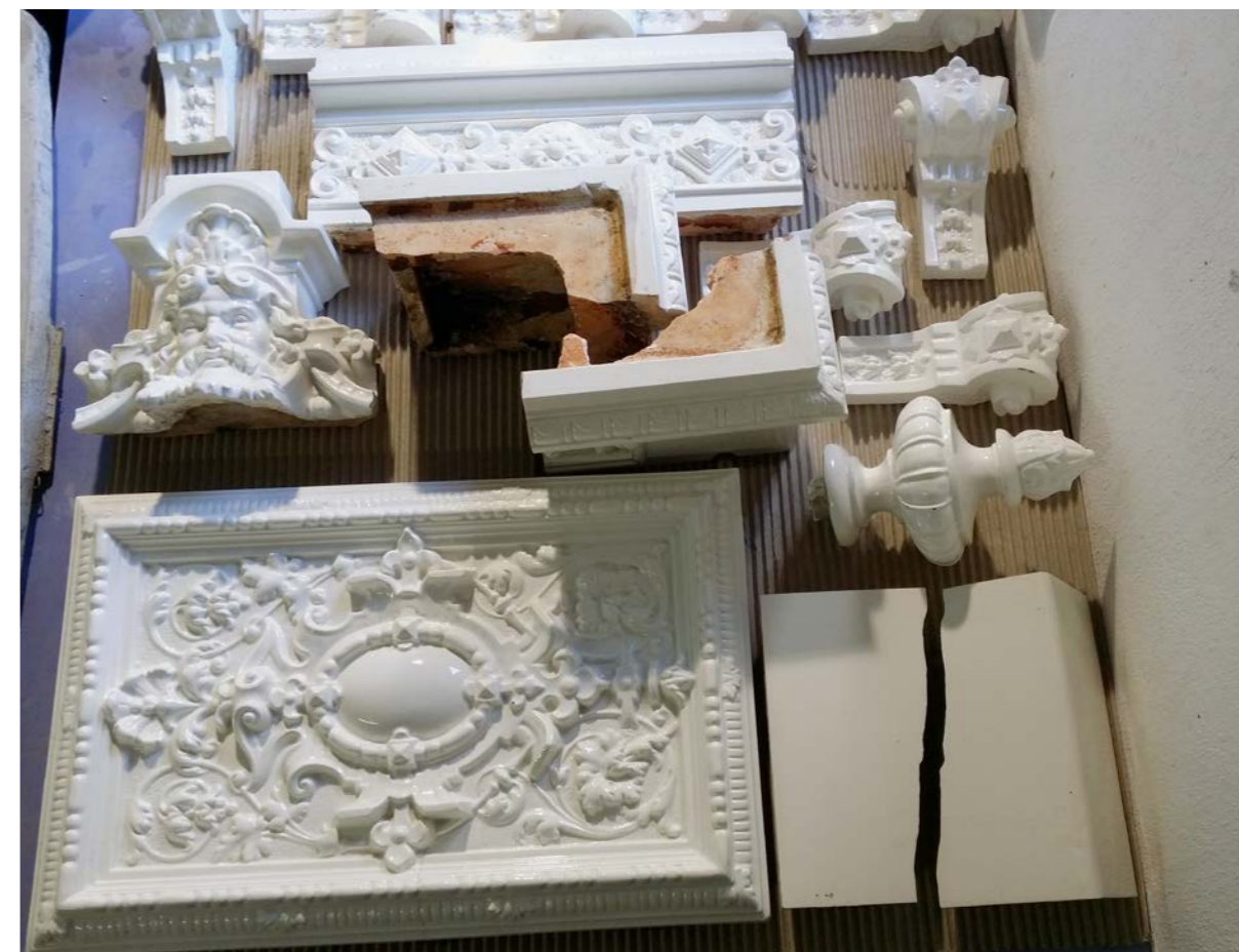
Opravy poškozených kachlů v dílně
