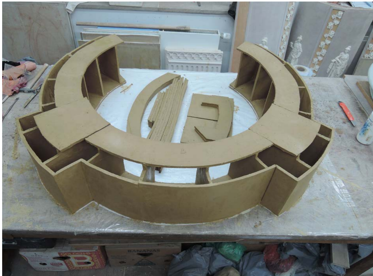
Celé nedochované kachle byly nově vytvořeny jako keramické kopie původní technikou tzv. bednění. Hliněné pláty byly sesazovány k sobě v celých řadách a poté rozřezány na jednotlivé kachle.
