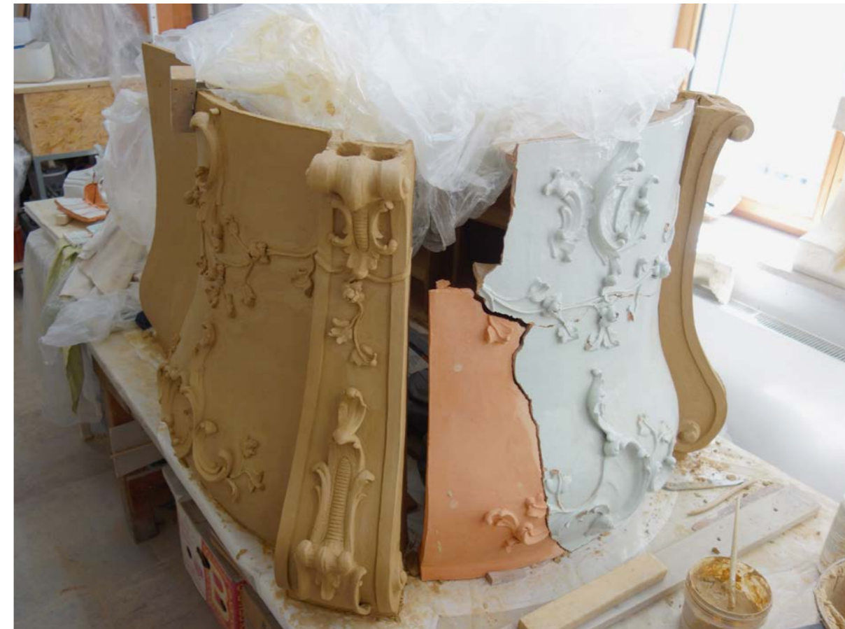
Stejným postupem byly vytvořeny i ostatní velkoformátové kachle. Dekor byl modelován z volné ruky podle dochované části originálu a analogií s tvarově obdobnými rokokovými kamny.
