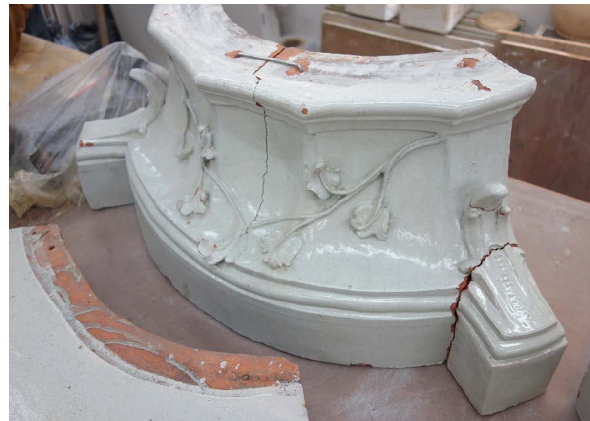
Nově vytvořené části sesazené s originálem (disperzní lepidlo Dispercoll D2, ze zadní strany žáruvzdorné keramické plomby).
