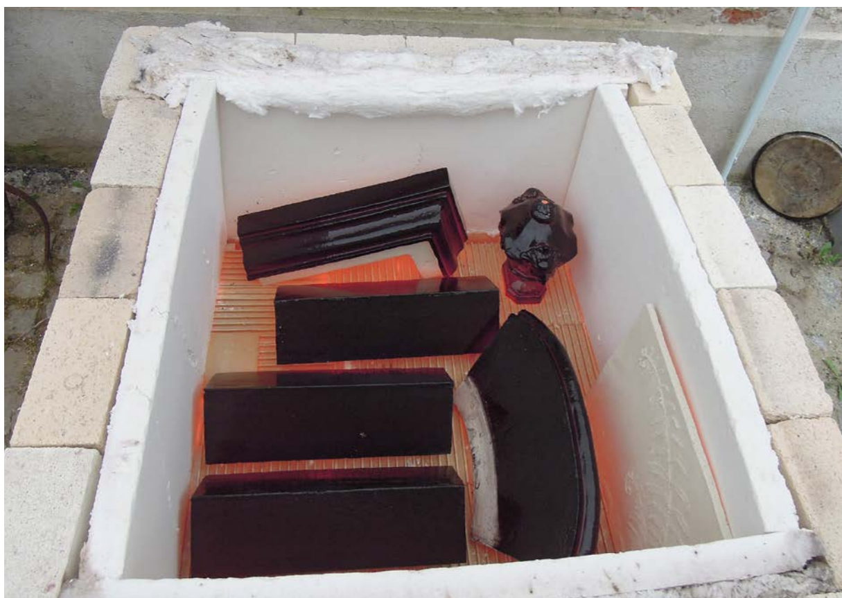
Kopie kachlů byly vypalovány v plynové peci s použitím techniky raku (vyjímání ještě žhavých kachlů a jejich vkládání do pilin, kde glazura redukuje bez přístupu vzduchu), kterou lze napodobit kovové odlesky na glazuru původního kachle vzniklé chemickým narušením glazury při dlouhodobém uložení keramiky v zemi.
