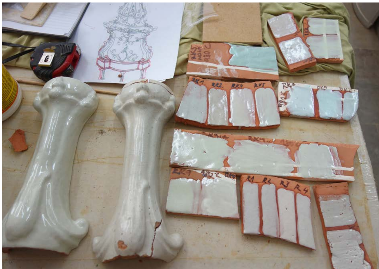
Pro nalezení odpovídající barevnosti byly páleny zkušební vzorky glazur. Jako základ posloužila glazura DW 106 v kombinaci s bílou krakelovací glazurou A 1095. Směs glazur byla upravována přidávkou dalších oxidů – cínu, železa, manganu, mědi a keramických barviv. Výpal probíhal v plynové peci, která svým rychlým nárůstem teplotní křivky a přítomností plynů umožňuje napodobit vzhled historické glazury lépe nežli elektrická pec.
