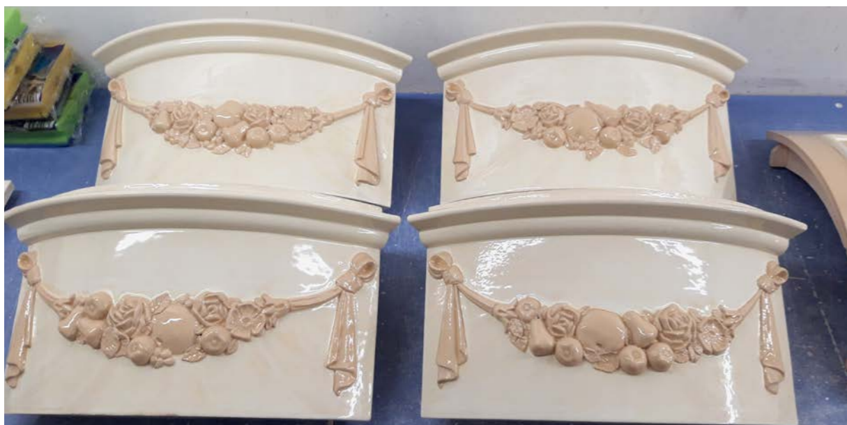
Hotové římsy po glazurovém výpalu
