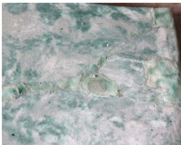
Ukázky postupu doplňování kachle 5/5 – chybějící místa, která byla v minulosti vyplněna kamnářským jilem. Menší fragmenty byly nalezeny při demontáži a nově přilepeny. Ostatní chybějící místa byla pro doplnění vyplněna keramickou hlinou. Po vypálení keramických segmentů zvláště v peci byly fragmenty přilepeny k originálu pomocí akrylátového lepidla Acrykleber 498 hv a poté zaretušovány části, které vznikly smrštěním materiálu, a to pomocí směsi kaolino-křídové hmoty Ceracell G a Ceracell F, Korest, bez přidavku pigmentu. Následovala tvarová modelace, barevná retuš pigmenty, 3x napuštění ředěným akrylátovým lepidlem a ruční zaleštění doplňků.
