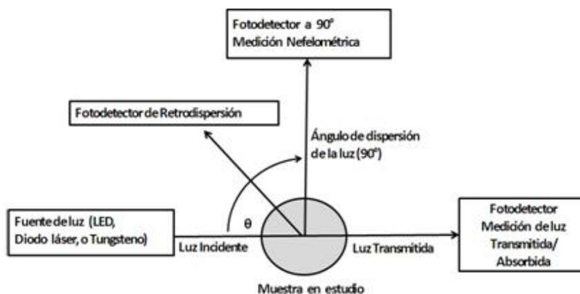
Fig. 2. Técnicas para la medición de turbidez.
