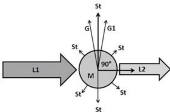
**Fig. 1.** Efectos de luz al atravesar la muestra.<sup>6</sup> **L1** Haz de luz incidente sobre la muestra. **L2** Haz de luz que ha pasado a través de la muestra. **M** Muestra en análisis. **St** Luz difundida por las partículas suspendidas en la muestra. **G** y **G1** Rayos periféricos del haz de luz difundido.
