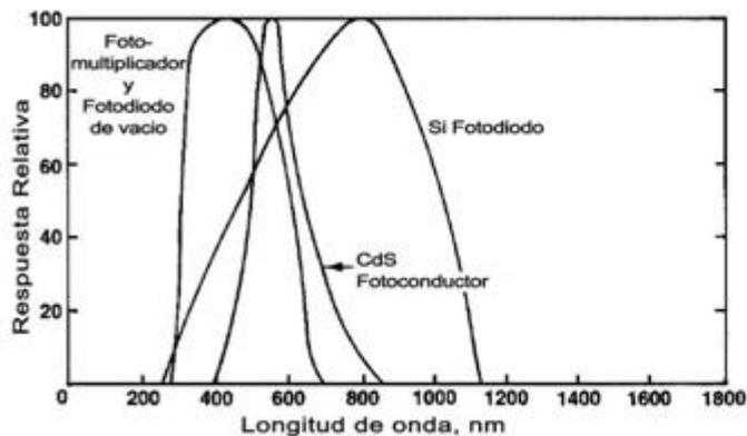
**Fig. 3.** Características típicas de la respuesta espectral de cuatro tipos de fotodetectores.<sup>23</sup>
