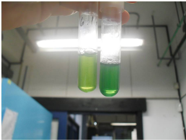
FIGURA 1. Cambio de color prueba Snyder. Cambio de color a las 72 horas, a una temperatura de 37°.
