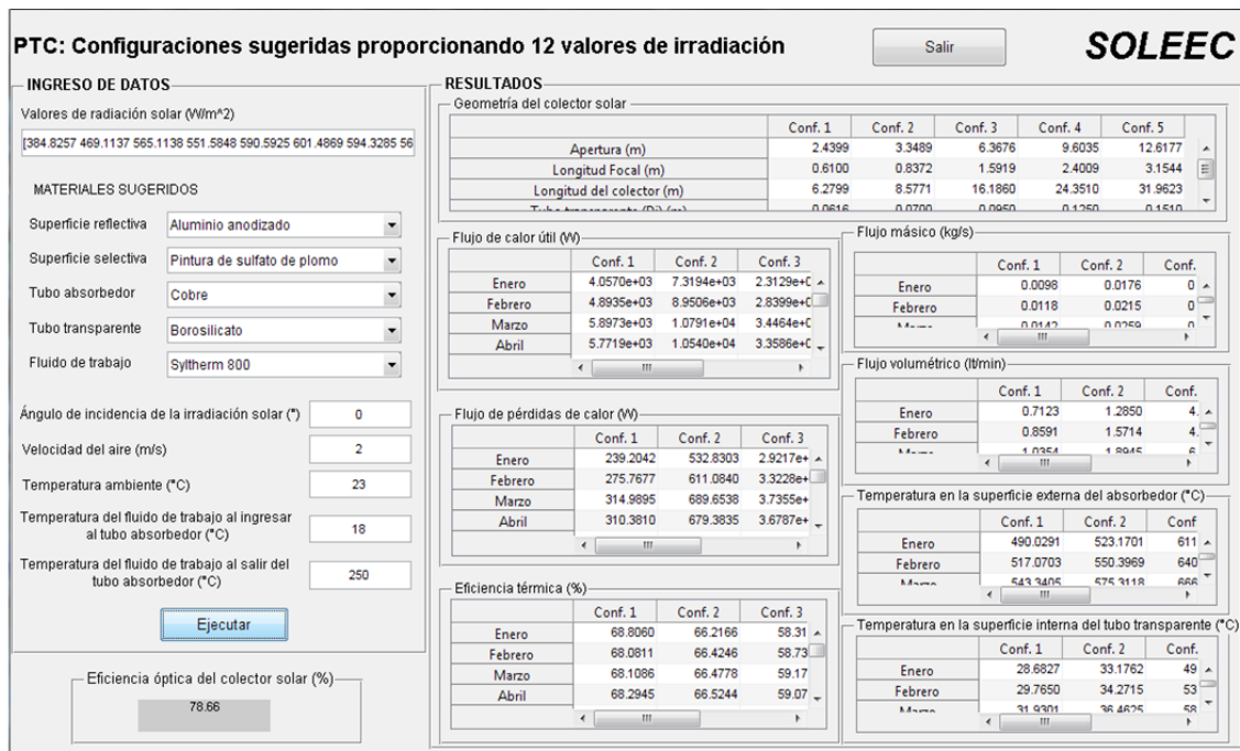
Figura 5.- Interfaz que muestra las características de diseño del concentrador PTC para evaluación anual.
