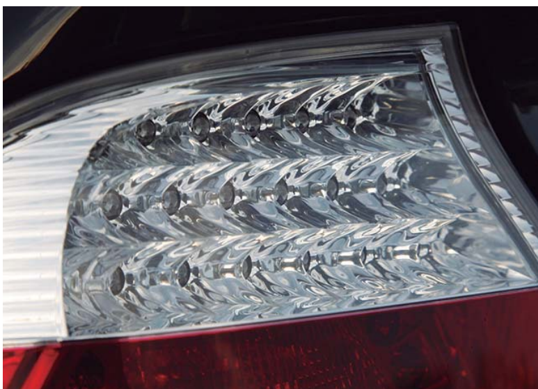
Figura 3. Luz trasera basada en LED, con fuentes de iluminación redundante para mayor fiabilidad.
