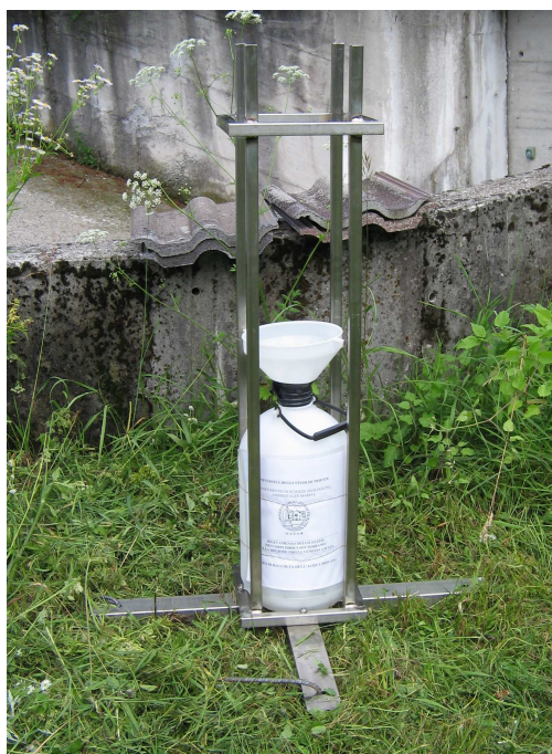
Figura 2.1.1: Uno dei raccoglitori installati.
