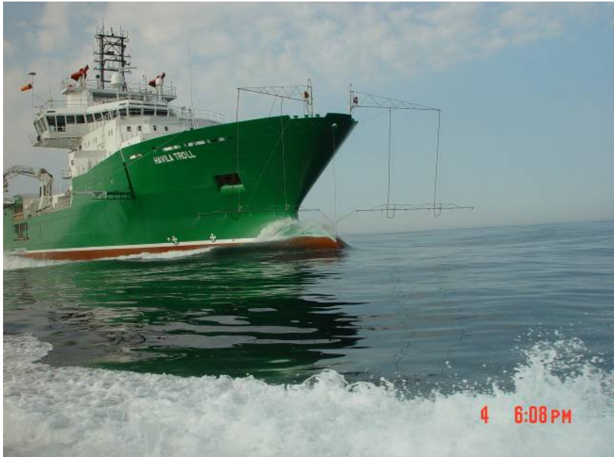
Figur 3.5 Påføringsutstyr for dispergeringsmiddel på "Havila Troll" (Foto: SINTEF).
