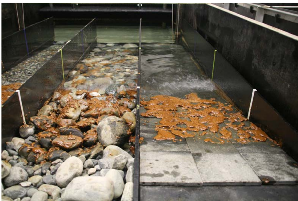
Figur 8.2 Testing av hvordan en forvitret olje kleber seg til forskjellige strandsubstrater og i hvilken grad flo og fjære kan påvirke utvasking. (Bilde: SINTEF).
