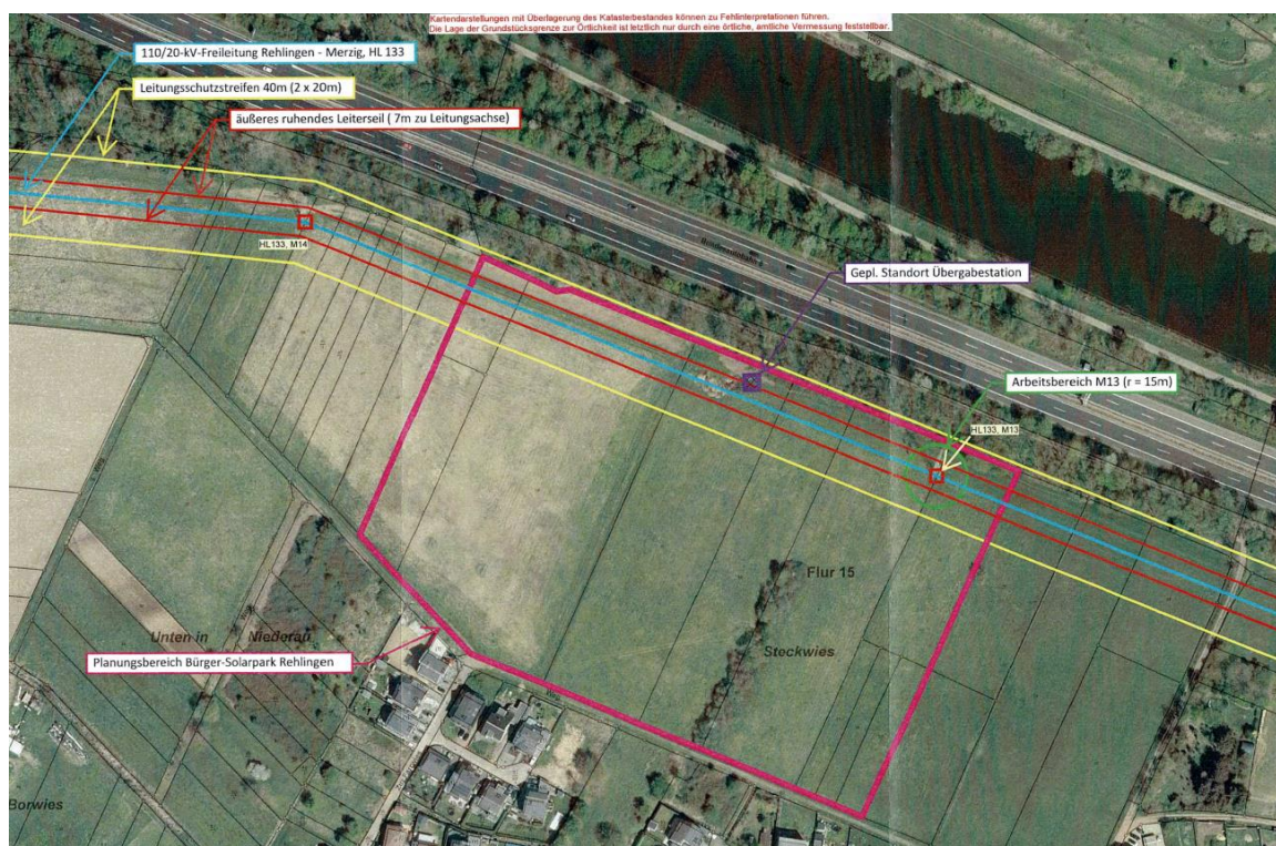
Abbildung 6: Verlauf der Freileitung mit Schutzstreifen
