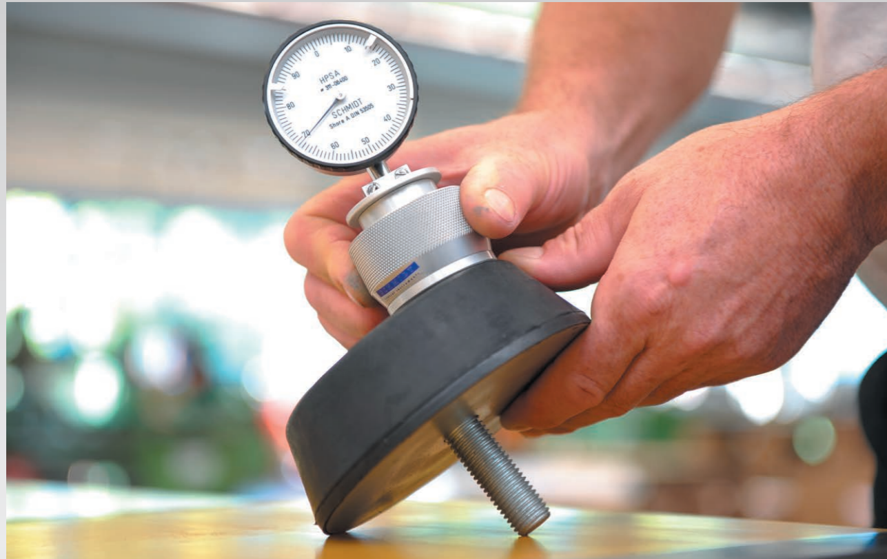
Die Shorehärte der Gummimischung beeinflusst die Schwingungsdämpfungseigenschaften wesentlich
