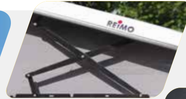
Extra stabiler Scherenmechanismus
