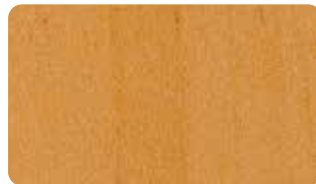
Apfel Pappelsperrholz mit 0,6 mm HPL-Beschichtung (High Pressure Laminate), beidseitig
