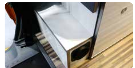
Einbaukasten für Standheizung Brano Ateso Alfa
