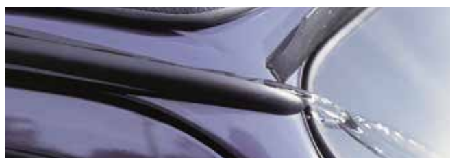
Wasserableitung über Spoilerprofil
