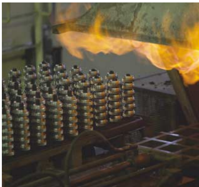
Traitement thermique des pignonneries de boîtes de vitesses en fonderie à l'usine de Séville.
