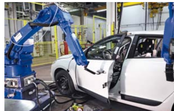
1. Renault Mégane berline : essais de compatibilité électromagnétique à Aubevoye. 2. Essais statiques : claquement de portière.
