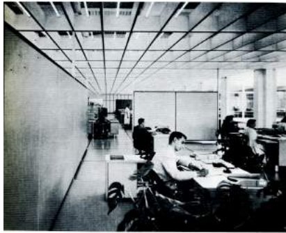
Die Architekt zeigt eine typische Arbeitsgruppe im Hauptgebäude. Die Trennwände, nur 2 Meter hoch und abgehängbar, lassen einen Blick über die Büros hinweg erheben. Dieser beugt in der vertikalen Gliederung des Raumes. Die Arbeitsplätze sind nicht abgetrennt, in eine Richtung gestellt, sondern werden sinnvoll in Funktionsgruppen zusammengefasst. Auch der Gruppenleiter im Vordergrund ist im Gegensatz zu den anderen auf seinen Tisch, Laptop, Schreibgerät und Pflanzensammlung etwas zurückgeworfen. Wände in dunkler Grautöne, ähnlich wie bei den Büros in der Hauptgebäude.
