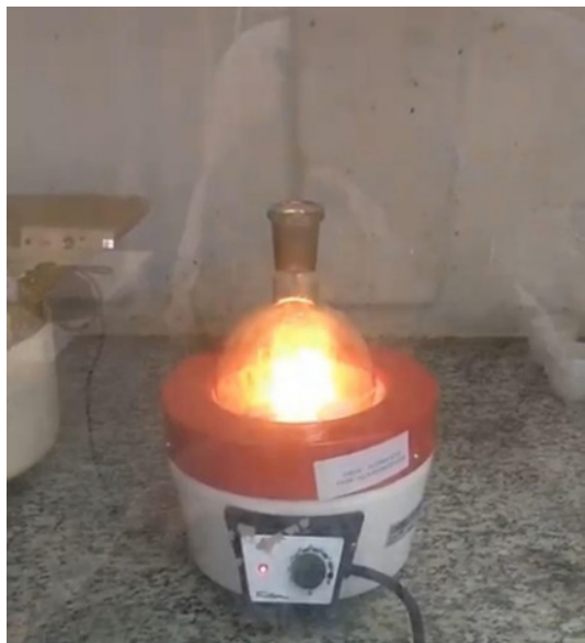
Figura 2. Ilustração do sistema de síntese e do momento da combustão
