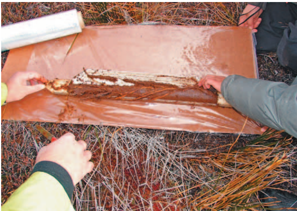
Figura 3. Sonda Rusa mostrando la recuperación de material sedimentario.
