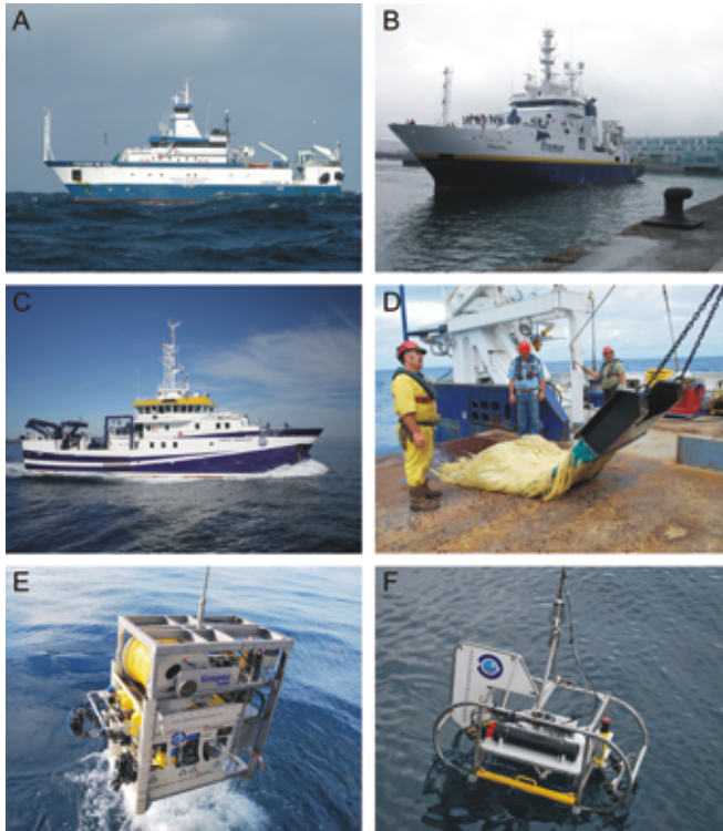
Figura 2. Equipos, técnicas y métodos de muestreo empleados en el estudio. Sampling equipment, techniques and methods used in the study. A) B/O Vizconde de Eza (53 m eslora/length). B) B/O Thalassa (74.5 m eslora/length). C) B/O Ramón Margalef 46.7 m eslora/length). D) Draga de Roca/Rock dredge. E) ROV Liropus 2000. F) Trineo fotogramétrico Politolana/Politolana photogrammetric sledge.
