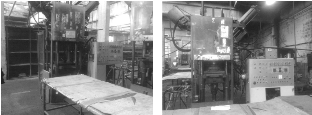
Слика 9. Изглед машине за бризгање са подигнутом заштитном оградом
