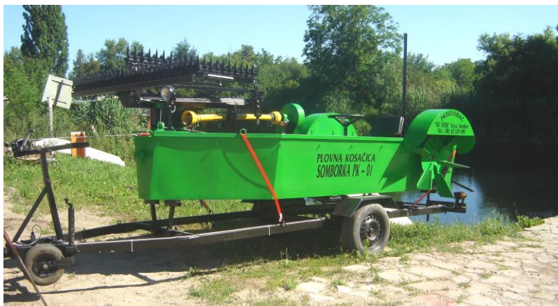
Слика 2. Фотографија самоходне пловне косачице, Тип "Сомборка ПК-01" (пред поринуће)
