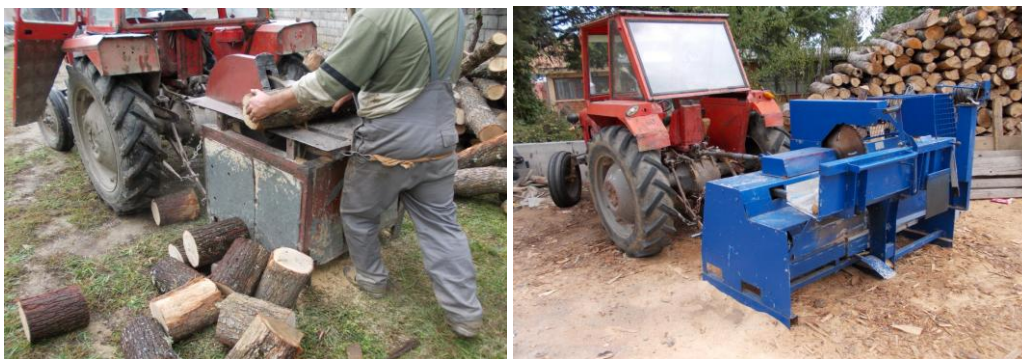
Слика 3- Маchine резање дрвета са кружном тестером прикључене на погон трактора
