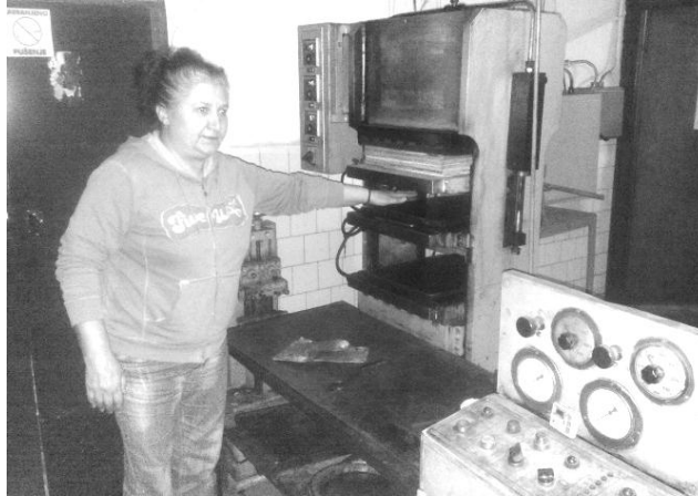
Слика 3. Симулација настанка опекотина приликом „пуњења“ пресе
