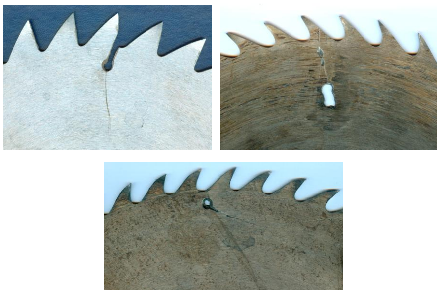
Слика 4- Употреба кружних тестера које су испуцале по ободу
