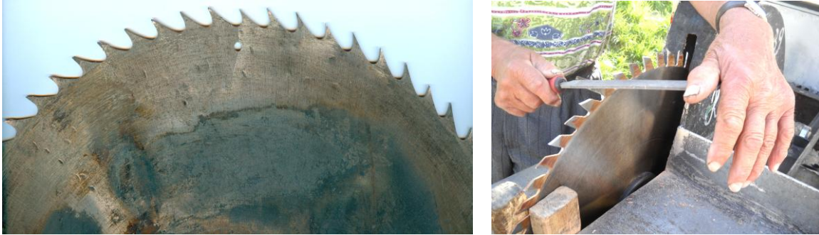
Слика 5- Кружна тестера која има вишеструке дефекте, ручно оштрење радног алата
