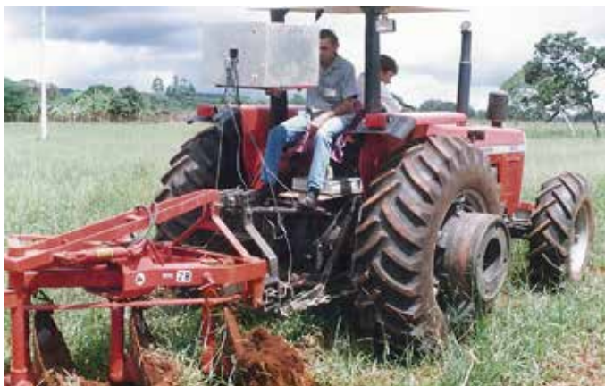
Figura 14. Coleta de dados durante avaliação de desempenho de um arado de discos com equipamento construído através do convênio Embrapa Cerrados/Jica.
