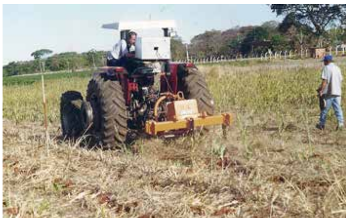
Figura 10. Avaliação do desempenho de um subsolador vibratório com instrumentação do convênio Embrapa Cerrados/JICA, para coleta de dados de demanda energética.
