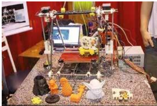
Figura 4: Impressora 3D montada pelo grupo PET Física – PET na Praça Fonte: Arquivo dos autores
