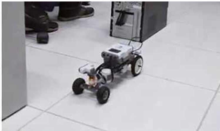
Figura 6. Carro robótico com sensor de infravermelho. Fonte: Arquivo dos autores.
