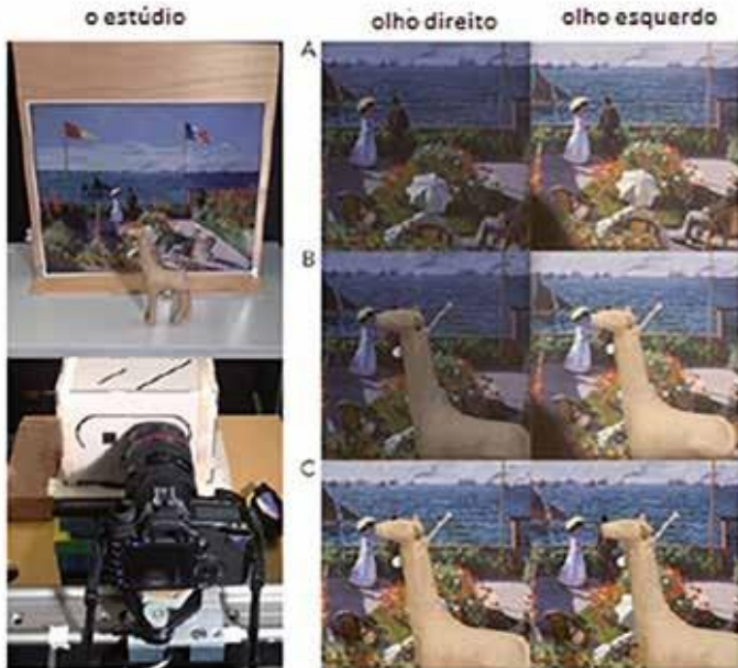
Figura 6: Arranjo experimental de figura bidimensional ao fundo e objeto tridimensional, um brinquedo em forma de girafa (posto em frente à fotografia utilizada) em imagens capturadas por câmara fotográfica a partir das aberturas dos olhos do sinóptero.
