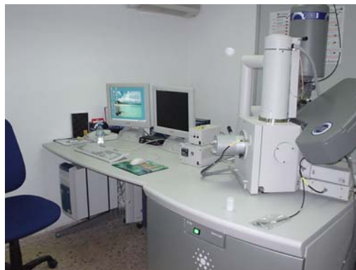
Figura 8: Instalações de MNCN – CSIC, Microscópio Electrónico de Varrimento utilizado com Analisador EDAX
