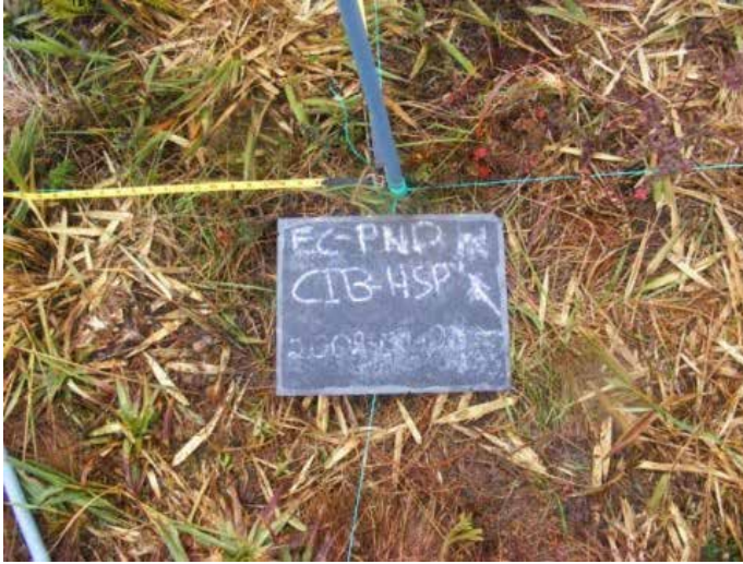
Figura 2. Marcación del PC en la cima CIB de la zona piloto del PNP, empleando un tubo de plástico.
