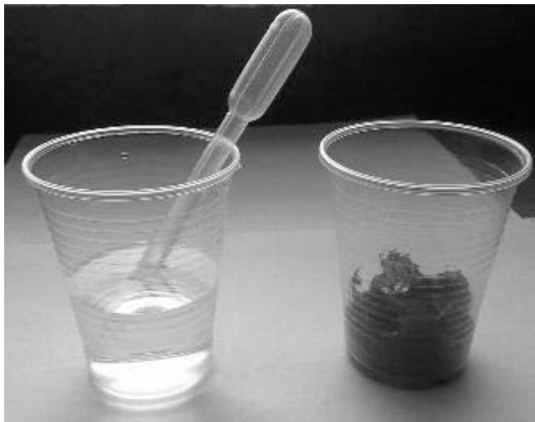
Рис. 2.5. Зволоження підстилки розчинами важких металів за допомогою піпетки
