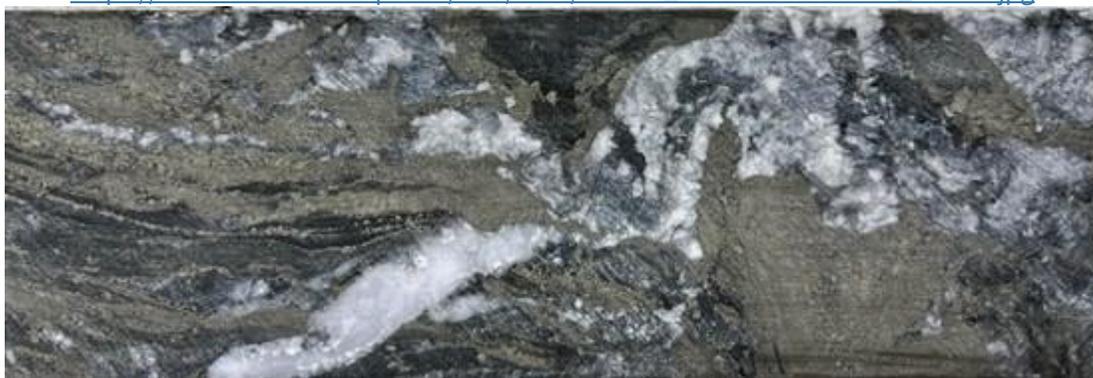
**Tafel 1:** Semimassiver Pyrit mit Eisen-Karbonat-Gängen in 346,5 m Bohrtiefe in Bohrung EM-22-005 (Durchstoßpunkt Nr. 5 in Abbildung 1); die Mineralisierung erstreckt sich von 346 bis 363,5 m Bohrtiefe. Die Analyseergebnisse stehen noch aus; NQ-Kern (47,6 mm Durchmesser)
