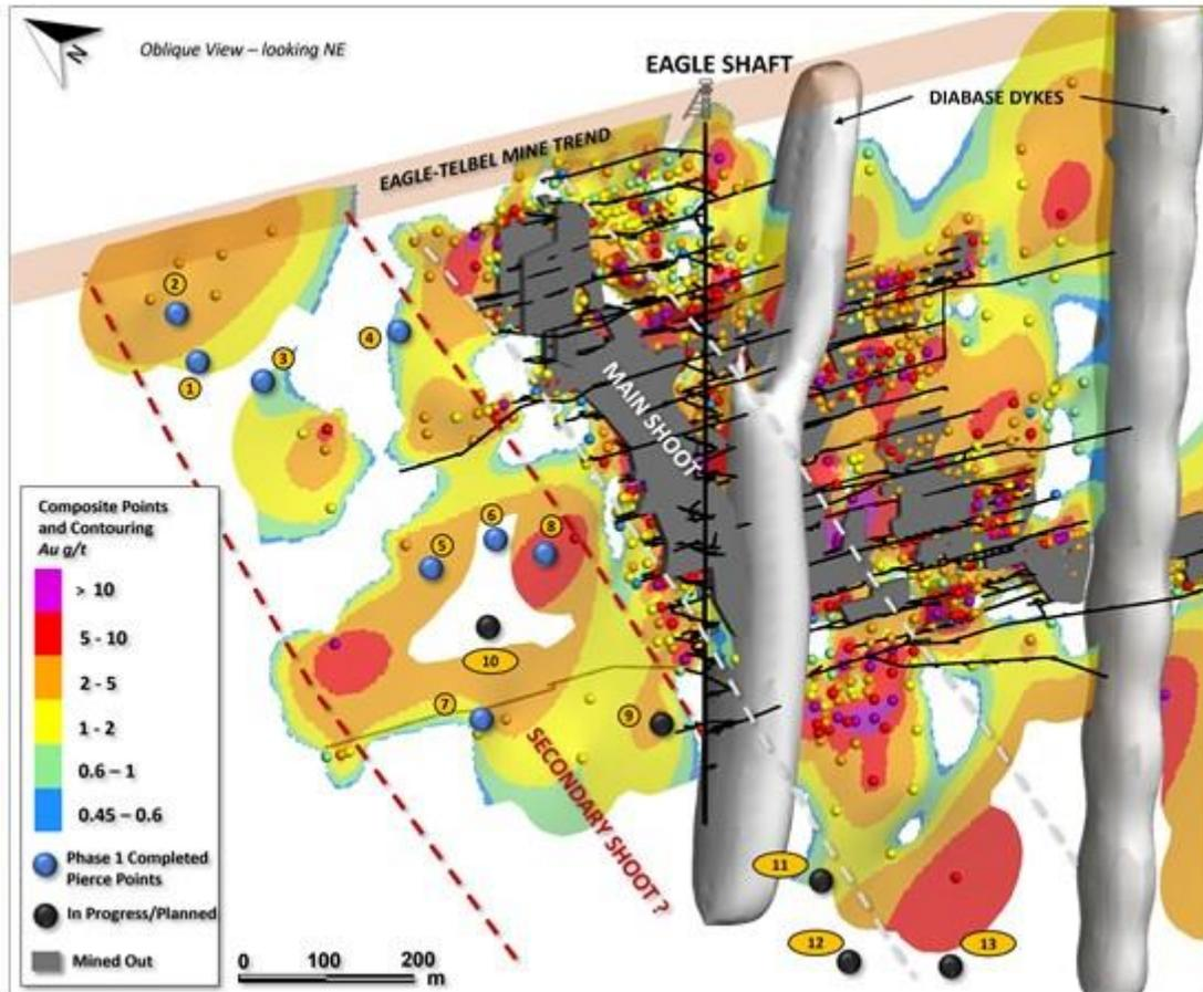
**Abbildung 1:** Schrägansicht des modellierten Minentrends bei Eagle mit den Durchstoßpunkten, die den fertiggestellten Bohrungen des Phase-I-Programms entsprechen, sowie den anvisierten Durchstoßpunkten für Phase II.
