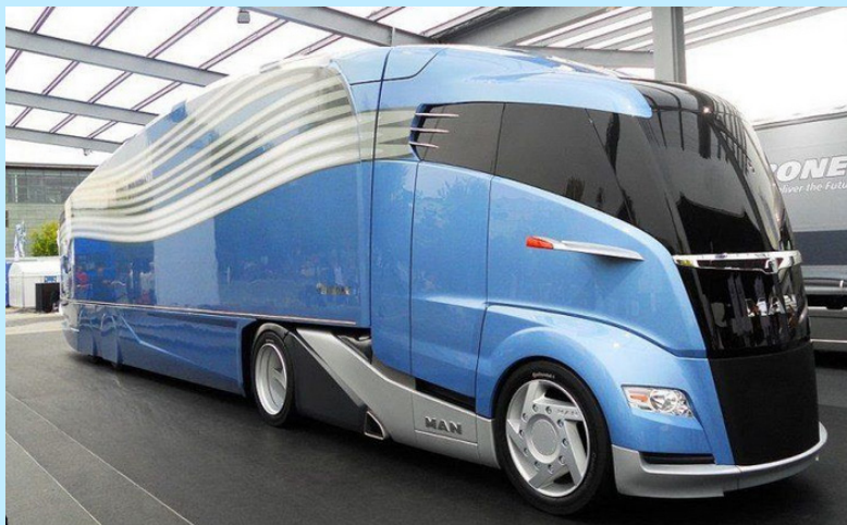
Abbildung 8: Prototyp des aerodynamisch optimierten Sattelzugs Aero Liner (© MAN Truck & Bus SE)
