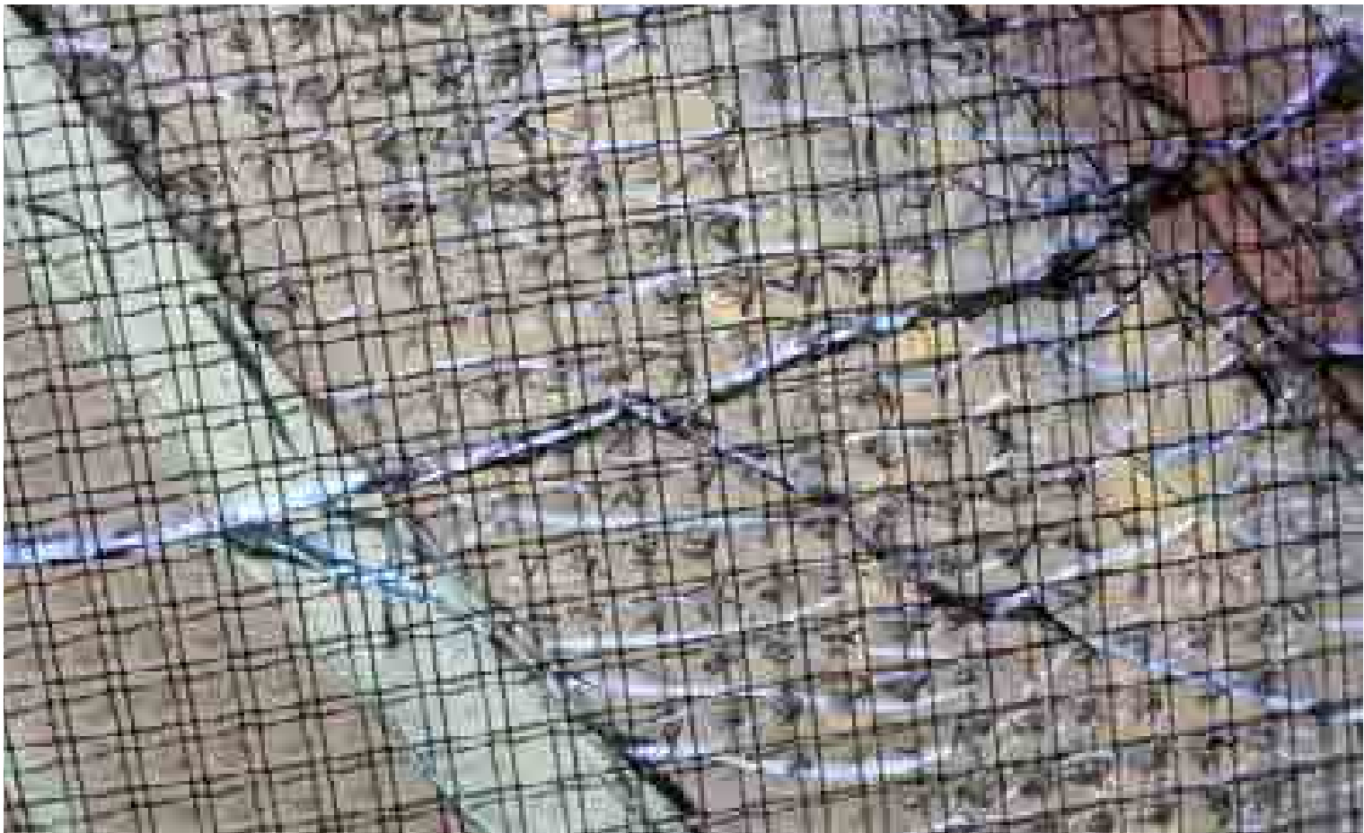
Gros plan sur le verre armé fusionné et les inclusions de verre coloré.
