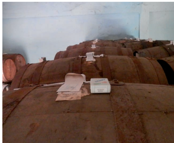
Figura 2. Ubicación del dispositivo de medición, sobre las duelas de uno de los barriles del nivel más elevado del anaquel y en las cercanías del tapón, que se utilizó para el llenado/vaciado de la barrica y del techo de la solera.
