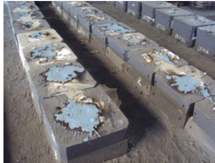
Figura 1: Corpos de prova já fundidos, aguardando tempo para desmoldagem.
