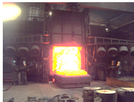
Figura 7: Abertura do forno TT03 para ser iniciado o resfriamento.
