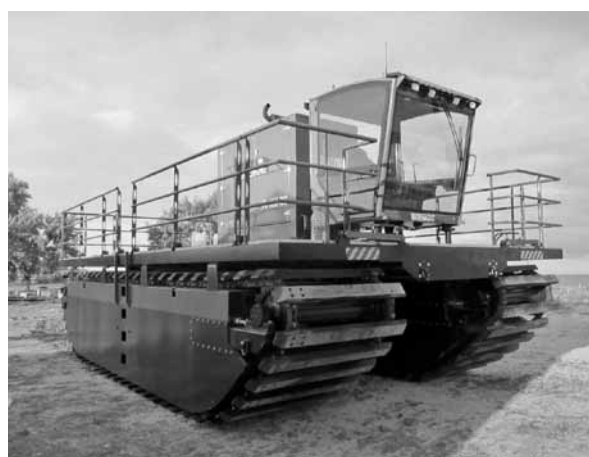
Рис. 3. Раскладчик приёмных устройств на базе гусеничной платформы-амфибии PL-150
