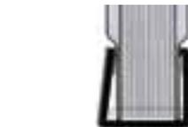
Durch die besondere Form der Schiene wird nur der hintere Teil beim Binden gebogen, die Vorderkante bleibt unverformt
