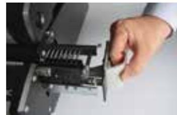
Stanzblöcke lassen sich innerhalb von Sekunden ohne Werkzeug auswechseln und werden automatisch in der richtigen Position verriegelt
