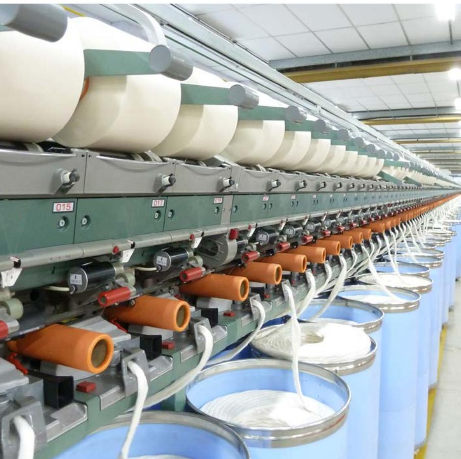
**Fig. 1** Después de las primeras instalaciones de la R 36, entre ellas la máquina más larga con 600 rotores, inmediatamente hubo más solicitudes.
