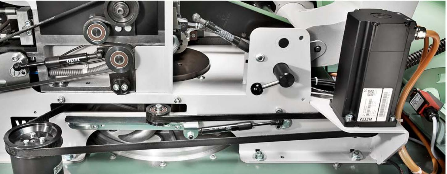
**Fig. 2** El servomotor del plato giratorio permite una optimización rápida de la velocidad.
