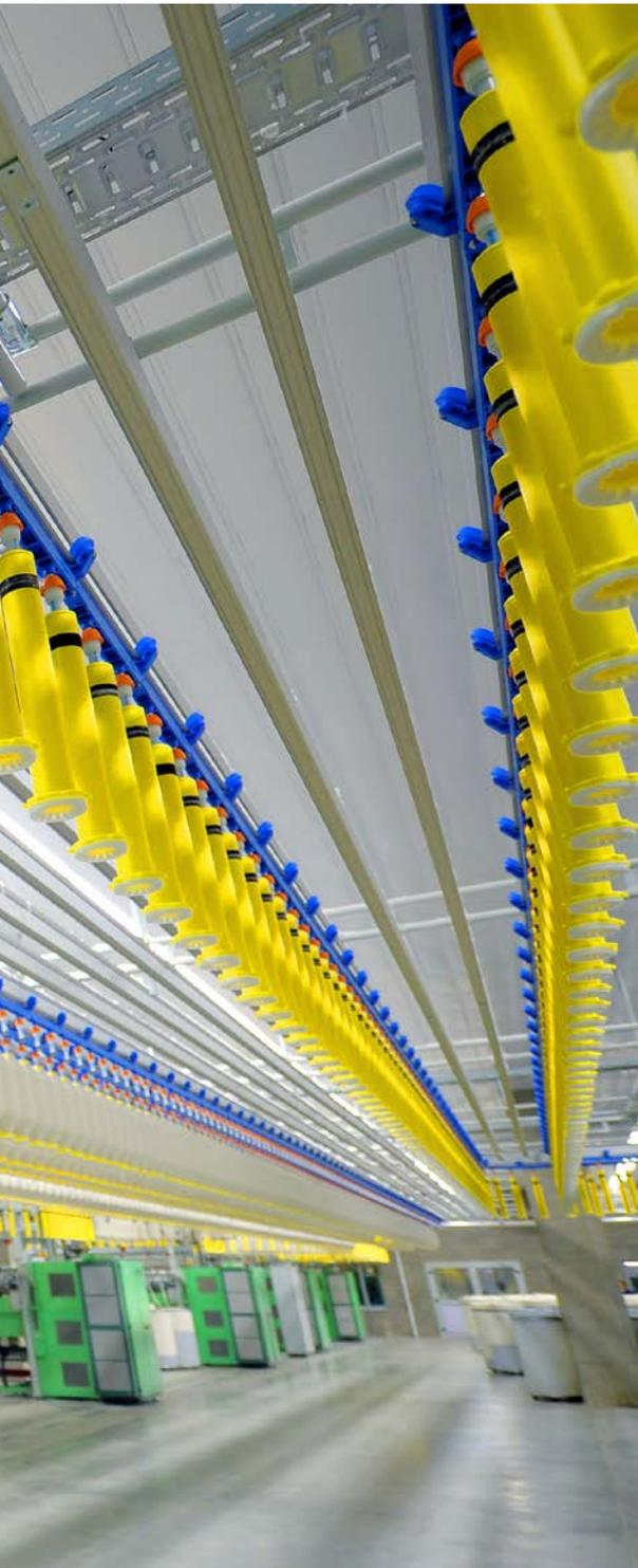
El sistema de transporte de bobinas de mecha modular SERVOrail ofrece el mejor caudal de material posible entre la mechera y el anillo – respectivamente las máquinas de hilado compacto (fig. 1). Cumple con los diferentes deseos de los clientes gracias a diferentes niveles de automatización. La construcción funcional del sistema y la combinación modular de la instalación del SERVOrail permiten la combinación de varios pisos y edificios.
