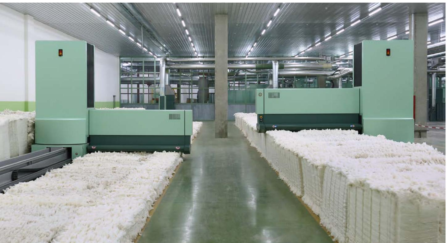
**Fig. 1** UNIfloc A 12 – la forma moderna y eficiente de deshacer balas en microcospos.
