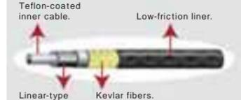
従来のアウターケーブルハウジングは、ブレーキが操作されるたびにインナーケーブルによって変形しています。その結果、ブレーキングのための入力の一部はアウターケーブルハウジングの変形に使用されて、ブレーキに伝達されないために敏感で正確な操作ができませんでした。BBBはその問題を解決するために高品質で高性能なケーブルを開発しました。
