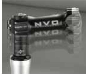
ATSの最大の長所は自由自在にステム高を変えることができること。自分に最適な高さを決めればあとは付属のカッティングツールで切断も簡単。ヘッドのベアリング調整なし。面倒なヘッドスペーサー調整から解放されます。
