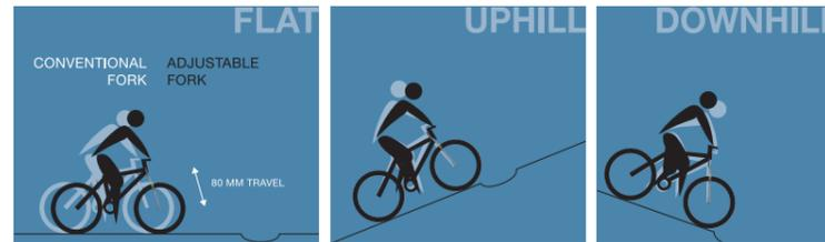
SR SUNTOURのサスペンションフォークは、もし80mmのストロークを使用した場合、平坦路、登り坂、下り坂などあらゆる走行条件の中で、80mm以内で上下に作動し、路面からの衝撃を吸収してライダーの疲労を防ぎます。
