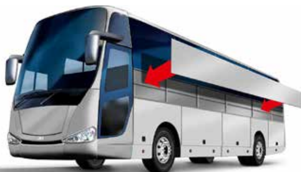
Verklebung von Karosserie-Anbauteilen
