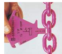
Prüfen, Teilungsverlängerung durch Nenndicken-Verschleiß
