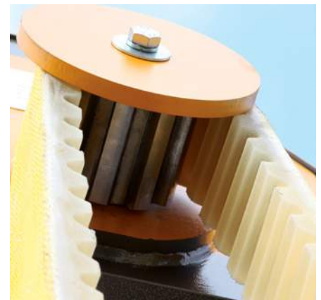
secuwave: Verzahnte Wenderolle und beschichtetes Hebebänder
