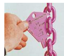
Prüfen, plastische Längung durch Überlast
