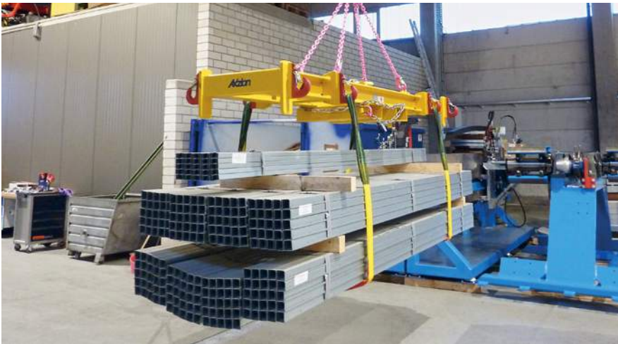
Rahmentraverse mit 4-Strang-Kettenaufhängung Mit Anschweißhaken und secutex-Hebebändern für gebündelte Stahlprofile
