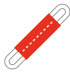
Abb. 3 mit Mittelnaht für Rundschnlingen über Doppelstrang
