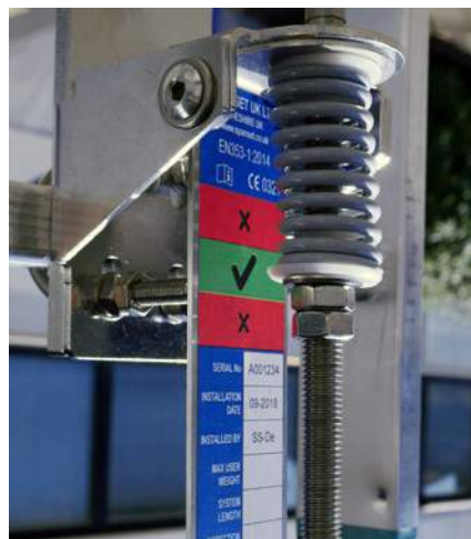
Eine Anzeige an der Spannvorrichtung hilft, die korrekte Spannung auf das Seil zu bringen.
