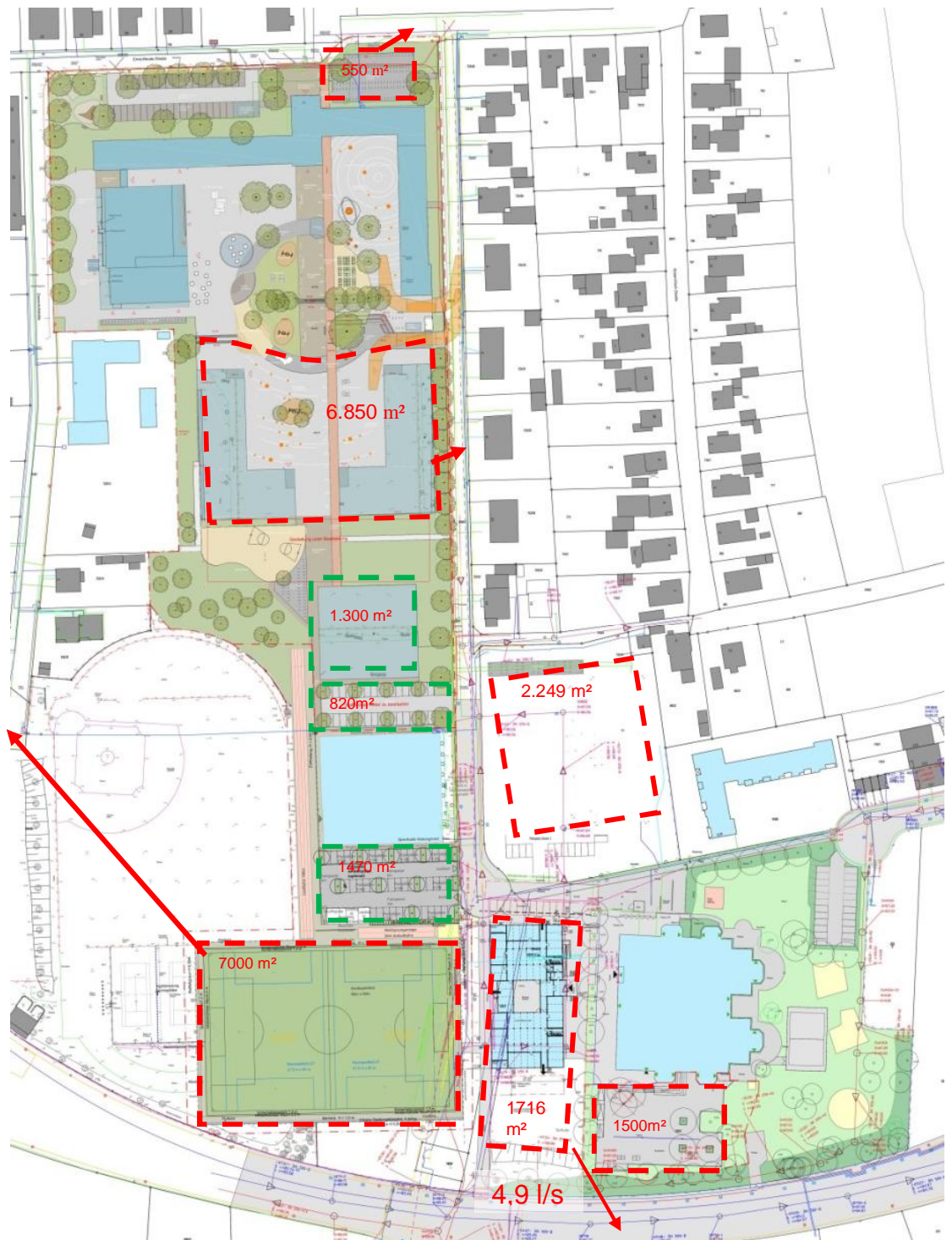
Abbildung 11: Ausschnitt aus der grafischen Kanaldatenbank Sanierung (rot an Kanalisation / grün Versickerung) für die kurzfristige Lösung
