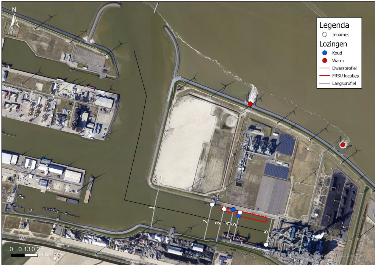
Figuur 4-12: Locaties van modeluitvoer: tijdseries op de locaties van innames en lozingen, dwarsprofielen 1 t/m 6 en het langsprofiel
