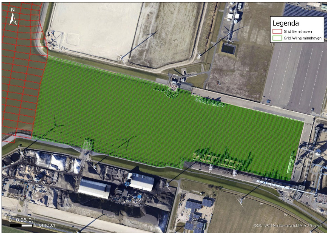
Figuur 4-3: Rekenrooster van de Eemshaven (rood) en het verfijnde rekenrooster van de Wilhelminahaven (groen)
