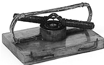
2.17. att. Jedlika elektromotors.
