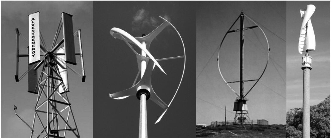
a) karuseļu tipa dzinējs b) firmas Quiet Revolution dzinējs qr5 c) Darjē dzinējs (vēja roze) d) spārnu dzinējs 2.27. att. Vertikālās ass vēja dzinēji.
