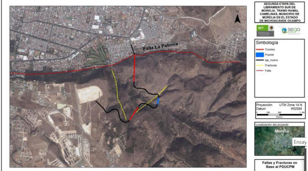
Mapa 5. Localización del proyecto “Segunda Etapa del Libramiento Sur de Morelia, tramo ramal Camelinas”, y la localización de las fallas geológicas que atraviesan el trazo carretero. Fuente: SCT (2012).
