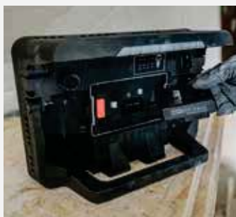
1. Adapter aufstecken Attach the adapter
