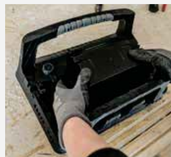
3. Schutzhaube schließen Close battery cover
