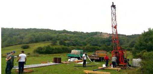
Слика 2. Бушење истражних бушотина на пројектованим локацијама Церничког поља (Сорајић & Милановић (2018) )
