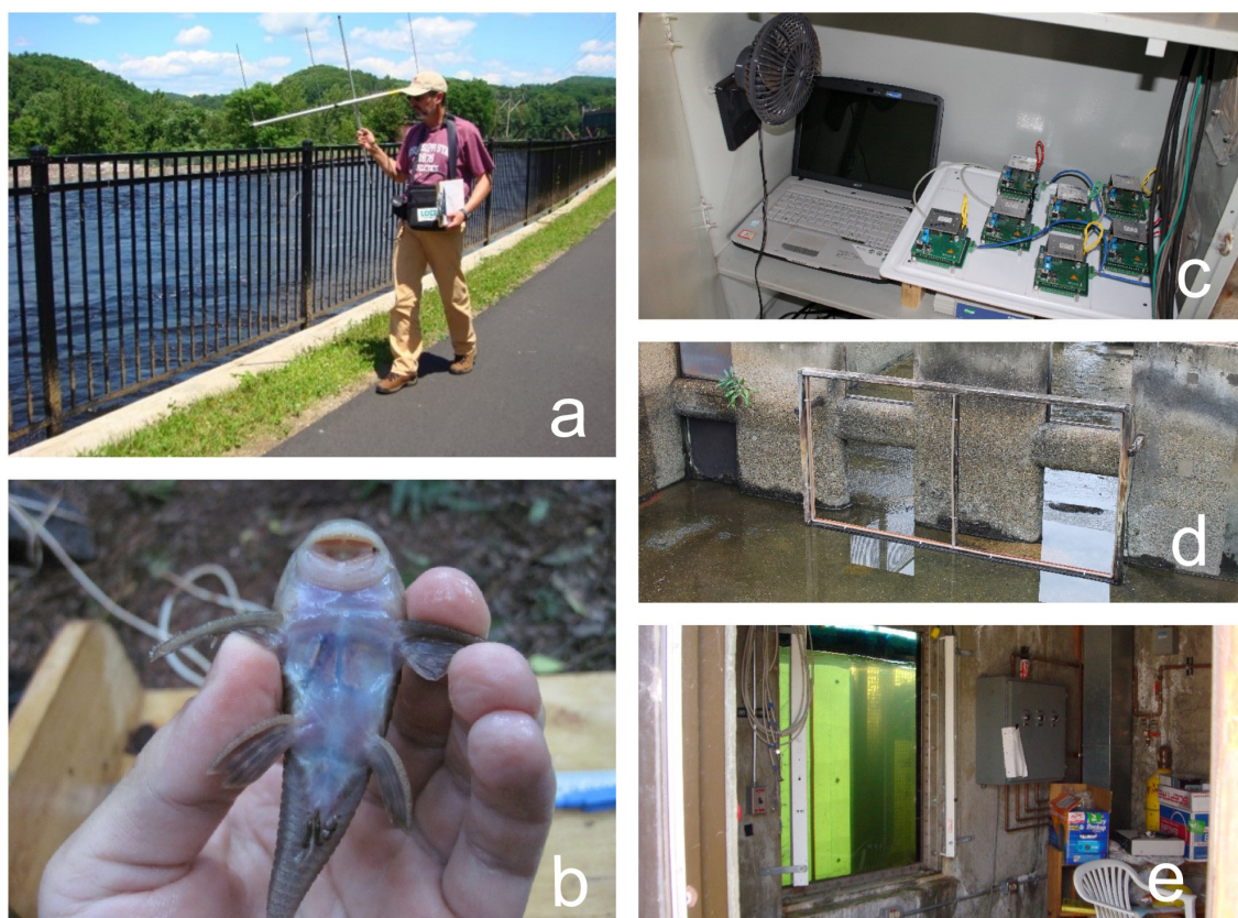
Figura 2. Sistemas para avaliação e monitoramento de sistemas de transposição para peixes. a) Rastreamento de rádio telemetria; b) Peixe marcado com PIT-tag de 12mm; c) Sistema RFID; d) antena de sistema RFID ( Radio Frequency Identification ); e) Sala para contagem visual.
