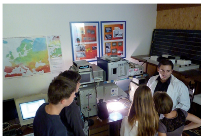
Obr. 3. Experimentálne cvičenie realizované žiakom zo Školy pre mimoriadne nadané deti (meranie V-A charakteristík FV článkov použitím solárneho simulátora ORIEL AAA)
