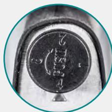
Einstellung des Drehmoments mittels Stellrad
