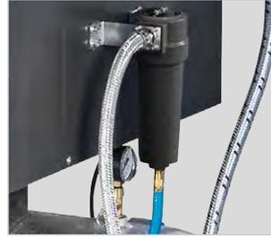
· Feinfilter als Filter vor der Druckluftentnahme zum Abscheiden von Kondensat und festen Verunreinigungen mit Partikeln bis 1 µm
